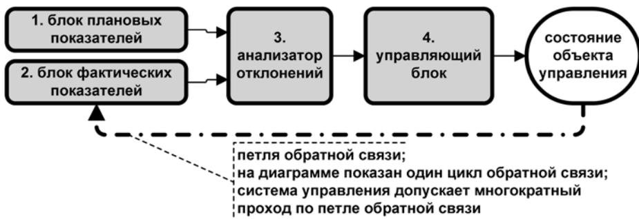
Рисунок 23. Графическое изображение одного цикла обратной связи
